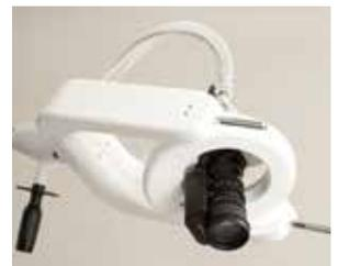
超音波モータ搭載旋回台
